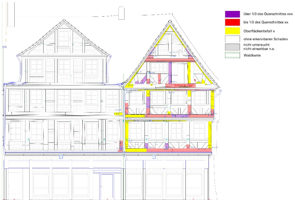
Bild 3: Auszug aus der Schadenskartierung in verformungstreuer Bauaufnahme 2023: Giebelfassade Fachwerkgebäude Am Markt 5, der linke Gebäudeteil (Am Markt 4) ist nicht Teil der Maßnahme
